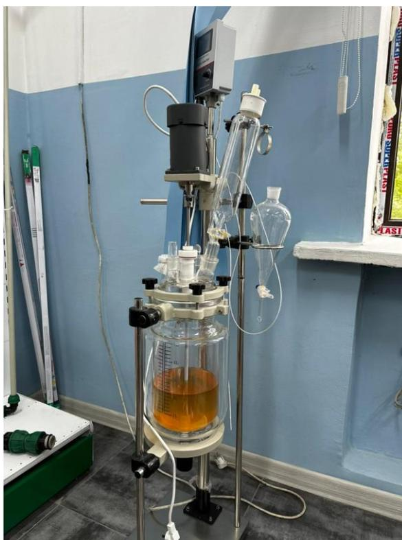
Фото 3. Лабораторной установки для бактериального выщелачивания.
