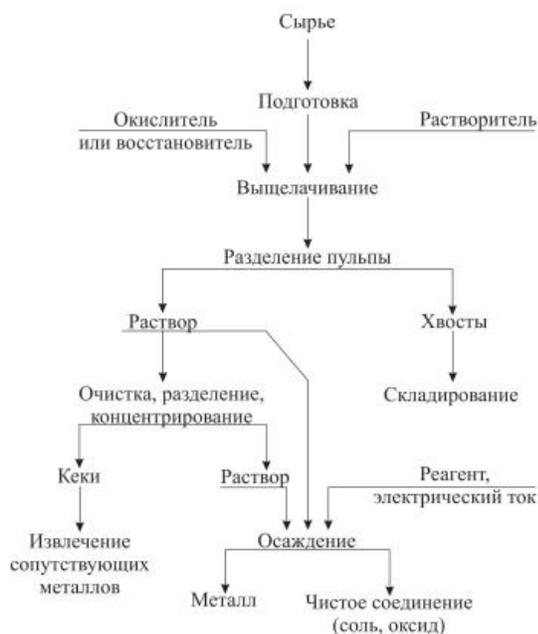
Рис.1. Принципиальная схема переработки сырья по гидрометаллургической технологии
